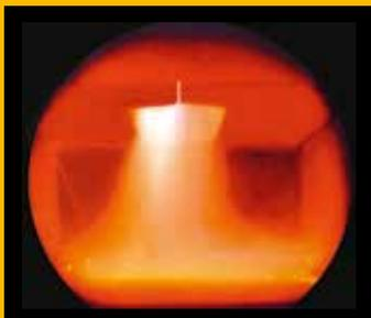
*Anhand des Wärmebildes wird deutlich, wie stark das Luft-Gasgemisch in der Glühzonen-Brennkammer verwirbelt wird. Diese ständige Bewegung trägt zu einer rückstandsarmen Verbrennung maßgeblich bei.*
