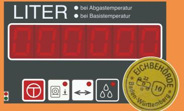
Verpflichtend: Der aktuelle Hauptstempel der Eichbehörde garantiert die höchste Genauigkeit der Messanlage. Dieses Siegel finden Sie auf dem Mengenzähler im Technikschrank des Tankwagens.
